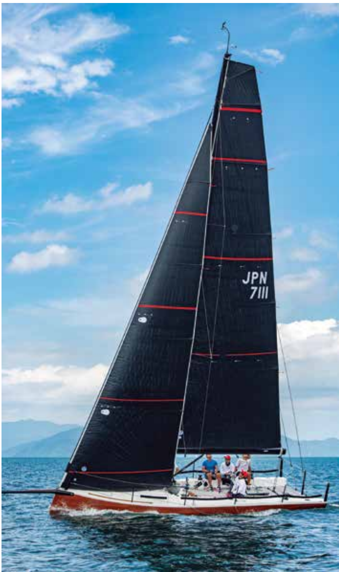
マストの高いセールプラン。メインセールはスクエアトップ。セールプランの開発にあたっては、ノースセール・ジャパンが全面的に協力した(写真のセールは3Di RAW)
