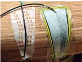
シラウドチェーンプレートは、カーボンクロスをハルの内と外にU字形に巻いて取り付ける。それに合わせ、ストリップの木材部分には微妙な凹凸をつけた上、バキュームで接着している
