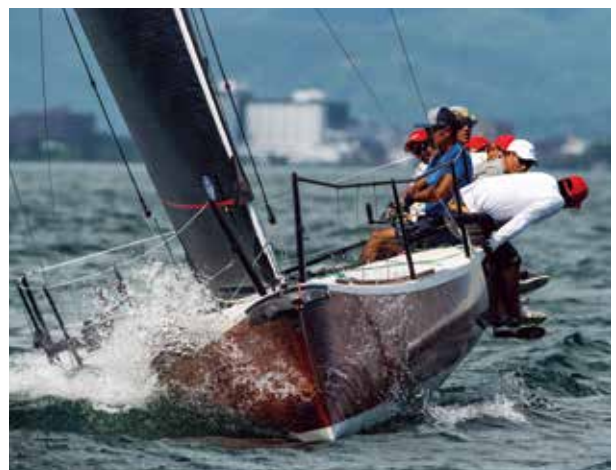
空気抵抗を突き詰めてデザインされた船首周りの形状に注目。木材は曲げられてもねじることができず、建造の際には梅川氏が最も苦労した箇所の一つだ
