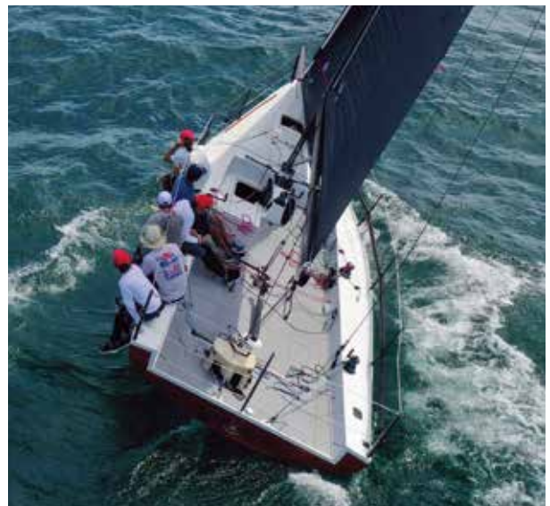
シンプルなデッキ配置がよくわかる。クルーバランシングもよく利いているが、トランサム右舷側ビルジを見ると、このあたりからハルフォームのスタビリティーターがマックスに利き出しているようだ
