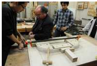
5 クランプによる曲げ材の固定
